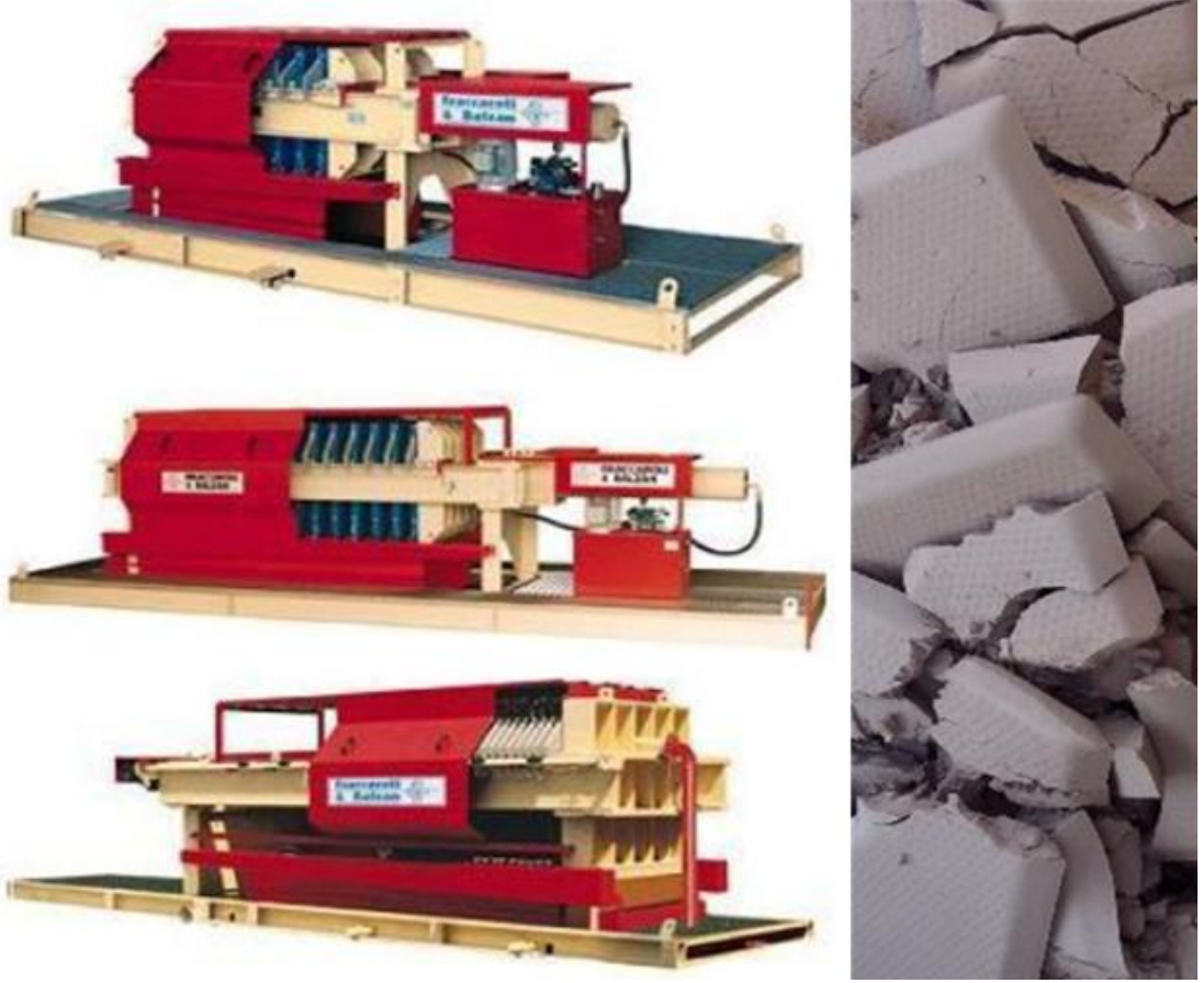
Resim 2.1: Arıtma tesisinden çıkan çamurun kek (sıkıştırılarak katılaştırılması) hâline getirilmesi
