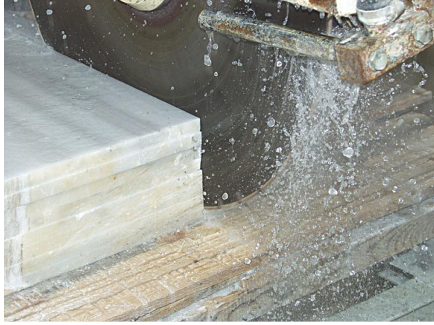
Resim 1.9: Elmas soketli dairesel testere ile sulu kesim
