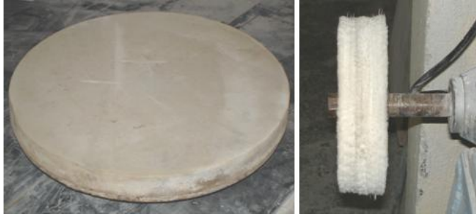
Resim 1.11: Pleyte yapıştırılmış ve mile takılmış keçe
