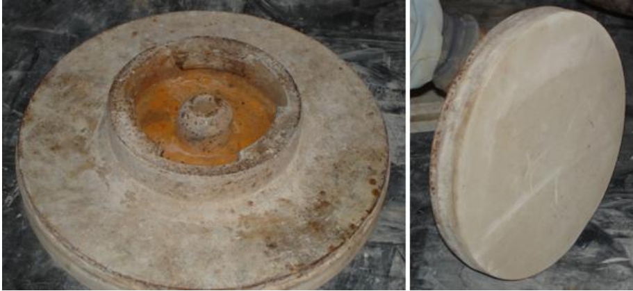
Resim 2.2: Pleyte yapıştırılmış keçe
