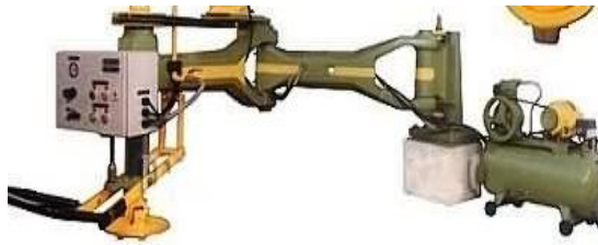
Resim 1.16: Perdah makinesinin pnömatik ünitesi
