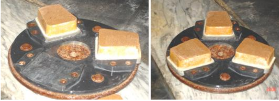
Resim 1.5: Aşındırıcıların pleyte takılması
