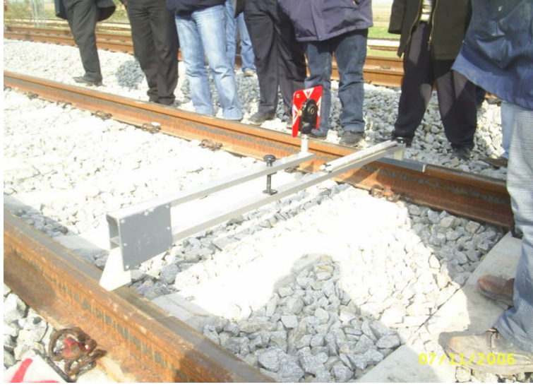
Resim 1.1: Yolun yatay düşey eksen arızalarının ölçülmesi
