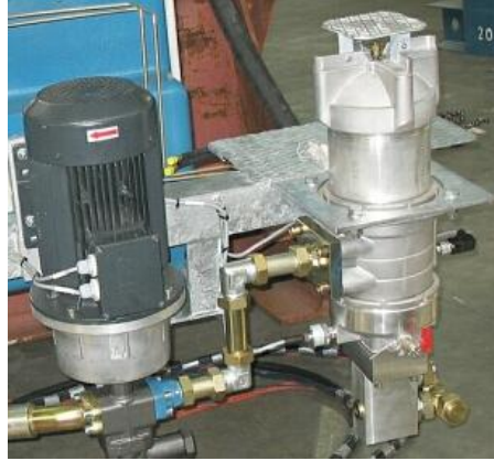
Resim 6.2 Şanzıman yağı filtresindeki yağ tahliye musluğu
