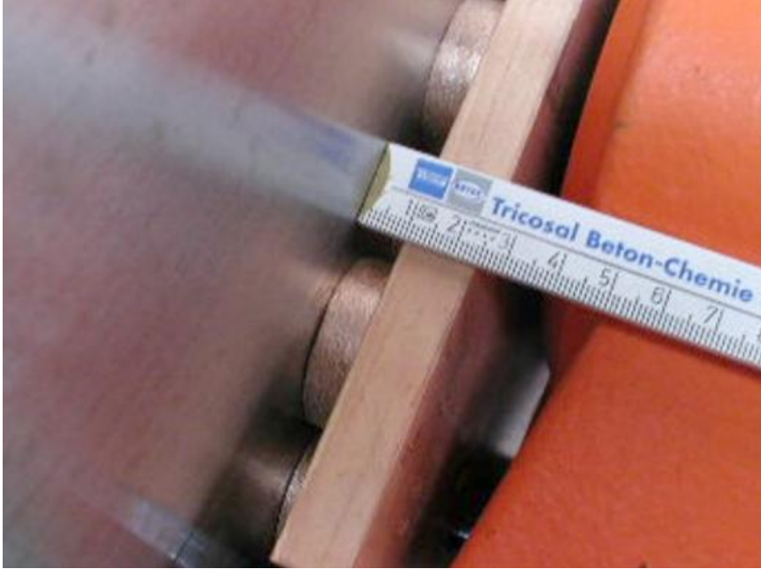
Resim 7.4: Fren balatası (örnek pasif fren)
