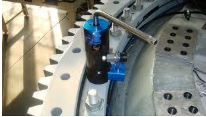
Resim 1.2 Hidrolik torkmetre ile uygulama
