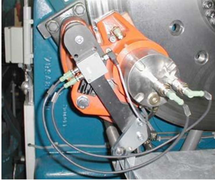
Resim 7.5: Rotor Frenindeki Sensörler
