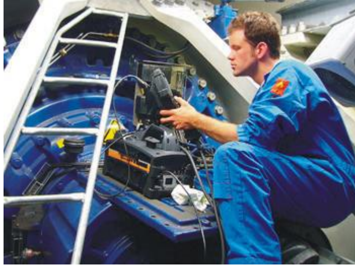
Resim 2.2: Jeneratörde ölçüm yapan teknisyen
