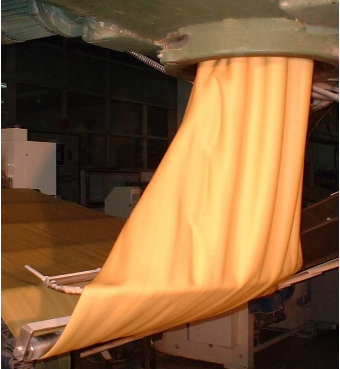
Resim 1.25: Stampa/levha kesme makarnalarda hamurun açılması
