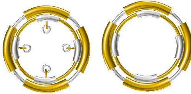
Şekil 3.10 : İçteki şarnel ve bağlantı parçalarının montajının yapılması
