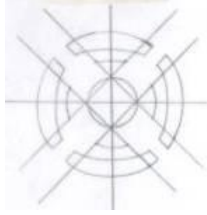
Şekil 1.3: Şarnel çaplarının belirlenmesi
