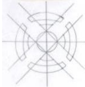
Şekil 3.3 : İçteki şarnel yerlerinin belirlenmesi
