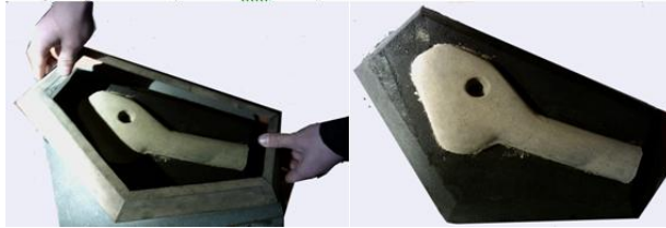
Resim 31: Maça ceketinin kumla sıkıştırılması Resim 3.2: Maçanın kum yatağa alınması
