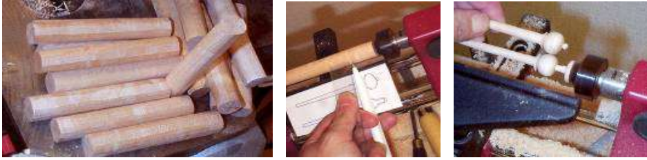
Resim 1.21: Burguların torna makinesinde hazırlanması
