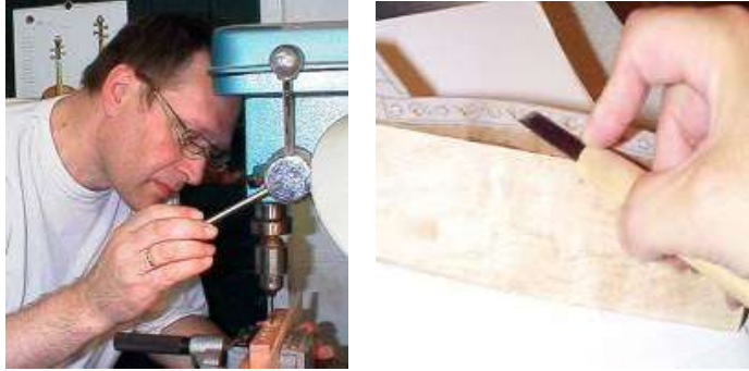
Resim 1.13: Burgu deliklerinin delinmesi ve delik yüzeyinin temizlenmesi
