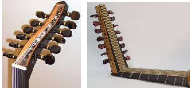
Resim 1.17: Sapa montajlanmış burguluklar
