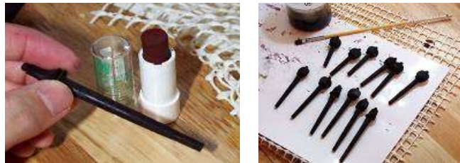
Resim 1.24: Burguların boyanması ve verniklenmesi
