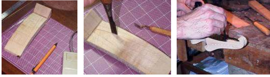
Resim 1.9: Burguluk iç kısmının boşaltılması
