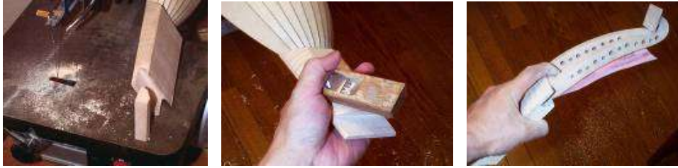
Resim 1.16: Sapın burguluğa alıştırılması
