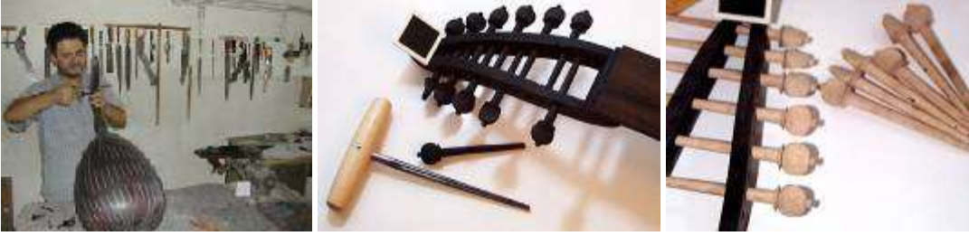
Resim 1.25: Burguların yerlerine alıştırılması
