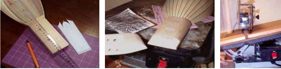
Resim 1.15: Sap kısmının ve burguluğun markalanarak açılı kesilmesi
