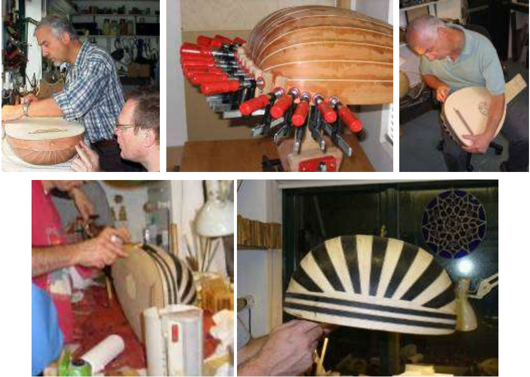
Resim 2.6: Tekne siperi (aynalık) yapım aşamaları
