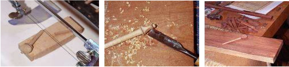
Resim 1.22: Burgu kulağının ve sap kısımlarının hazırlanması
