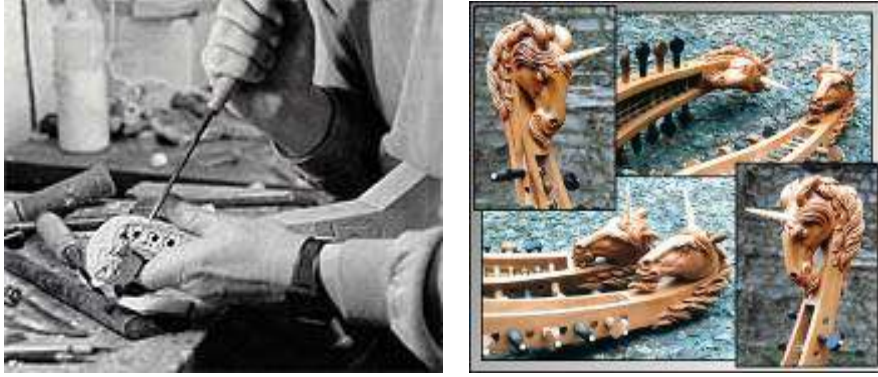
Resim 1.12: Lavta gagasının oyulması ve hayvan figürlü gaga örneği
