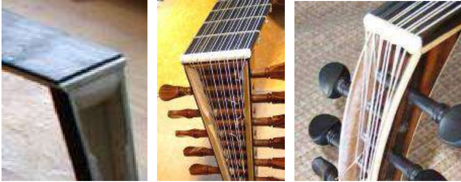
Resim 2.12: Üst eşik yeri ve eşiği takılmış lavta
