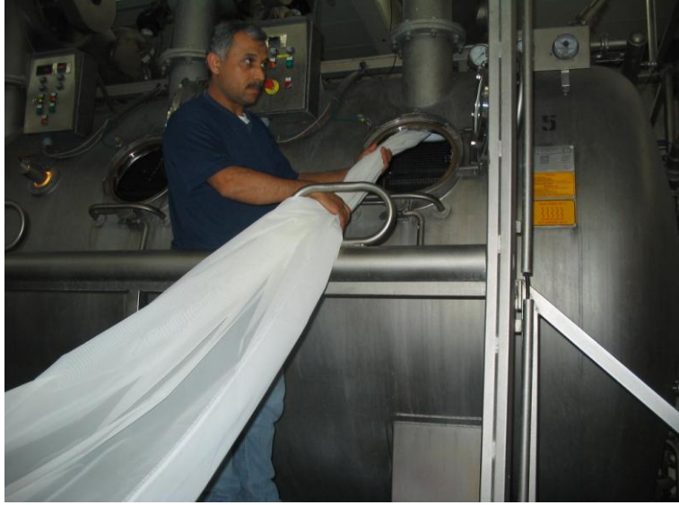
Resim 1.15: Kumaşın kılavuzdan geçirilmesi
