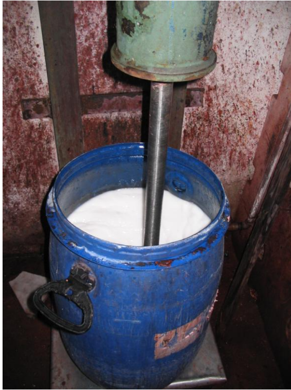
Resim 1.3: Boyar madde ve kimyasalların mikserle karıştırılması
