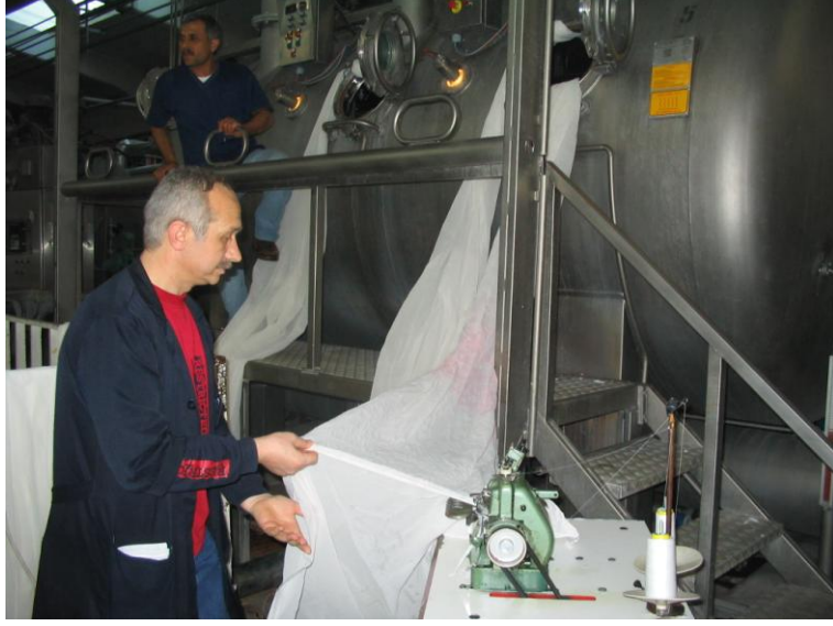
Resim 1.17: Sonsuz halat oluřturmak için kumařın iki ucunun dikilmesi
