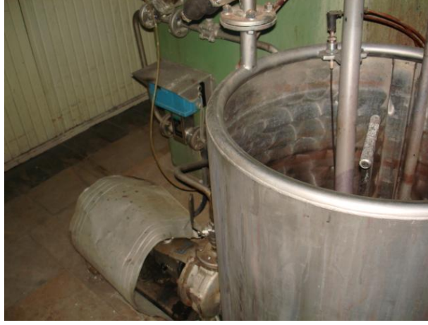
Resim 2. 15: Boyar madde - kimyasal madde hazırlama ve rezerve tankı
