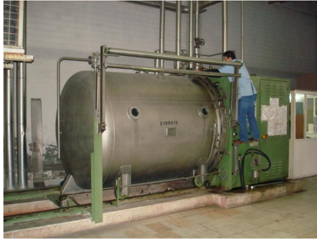
Resim 2. 12: Yatay otoklavı hareket ettiren ray sistemi
