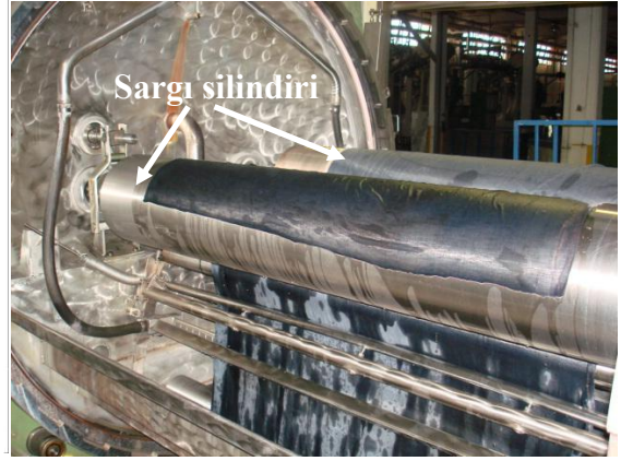
Resim 2. 1 : HT Jigger kumaş boyama makinesinin şeması ve sargı silindirleri
