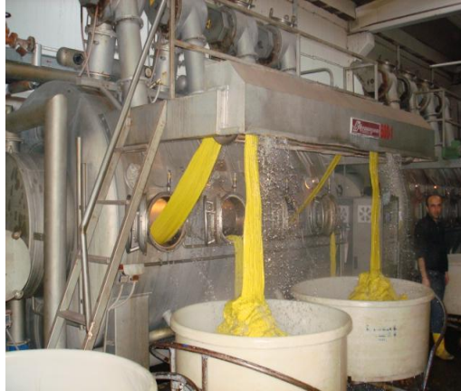
Resim 1.13: Kumaş yükleme boşaltma aparatı
