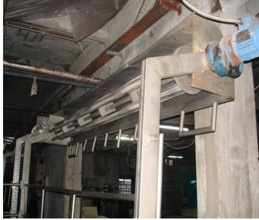
Resim 2.1: Kumaş yükleme boşaltma aparatı
