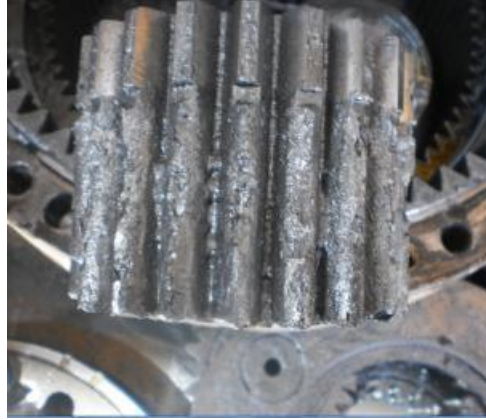
Resim 5.5: Gerekli bakımları yapılmamış bir pinyon dişlisi
