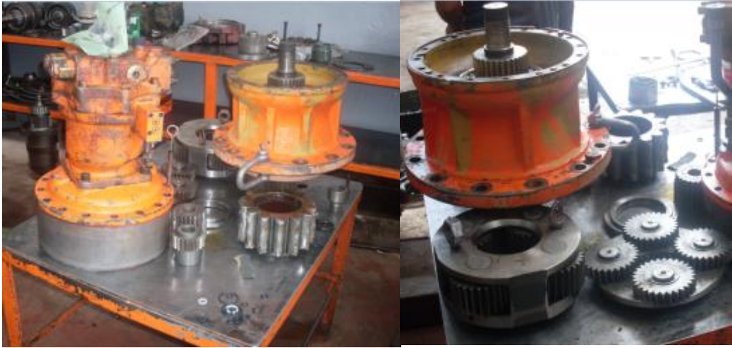
Resim 2.8: Makine üzerinden sökülmüş bir redüksiyon dişli kutusu
