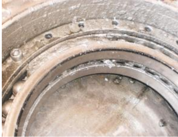
Resim 5.3: Deforme olmuş bir kule bilyesi
