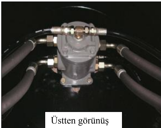
Resim 4.3: Makine üzerinde döner dağıtıcı üst kısım ve alt kısım görünüşü
