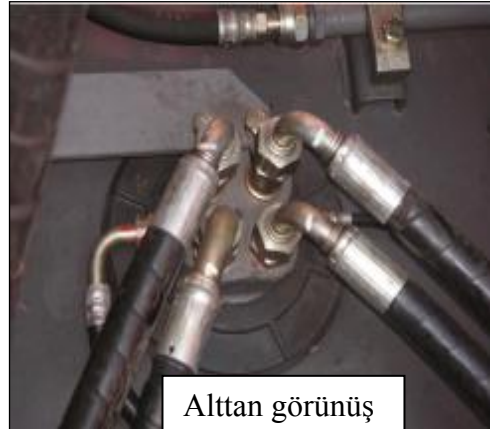
Resim 4.3: Makine üzerinde döner dağıtıcı üst kısım ve alt kısım görünüşü
