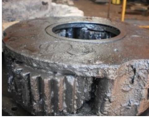
Resim 5.4: Gerekli bakımları yapılmamış bir planet dişlisi
