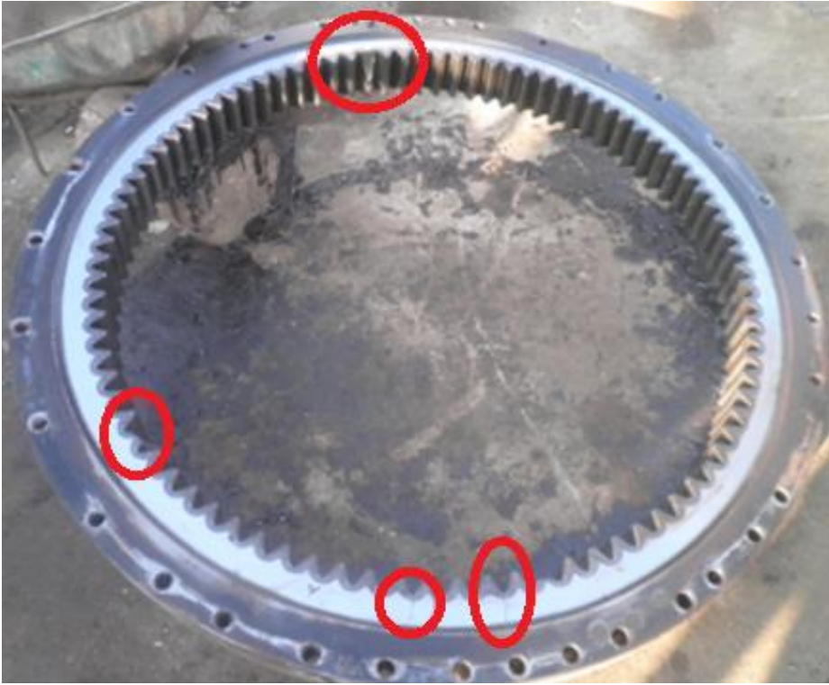
Resim 5.7: Farklı noktalarda çatlaklar oluşmuş kule dönüş dişlisi
