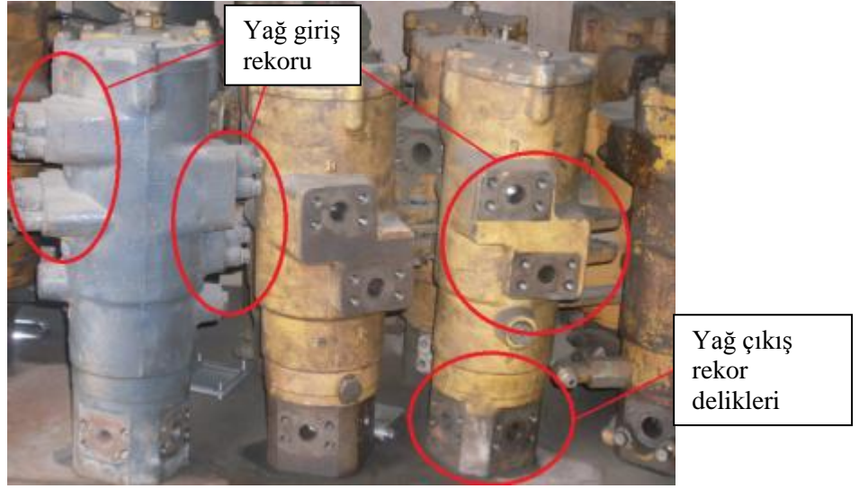
Resim 4.6: Döner dağıtıcı üzerinde yağ giriş çıkış delikleri
