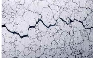
Resim 1.4: Taneler arası korozyon
