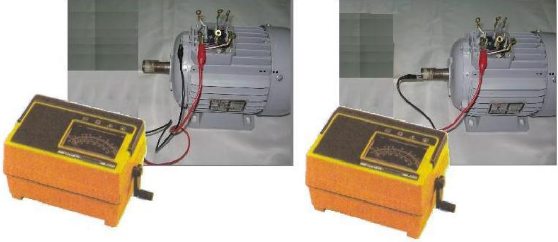
Resim 2.8: Sargılar ile gvde arası megerle yalıtkanlık kontrol
