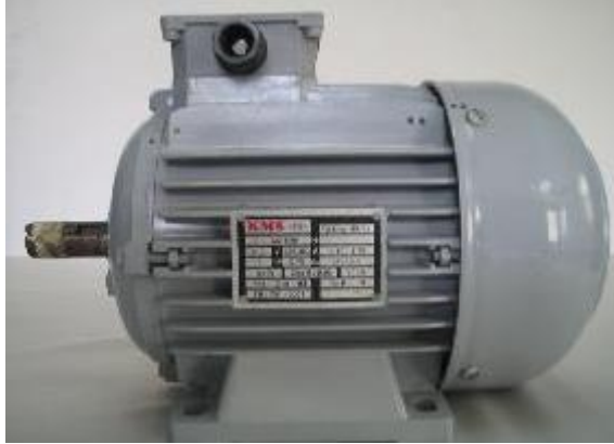
Resim 3.10: Koruyucu kapak takılarak montajı tamamlanmış motor
