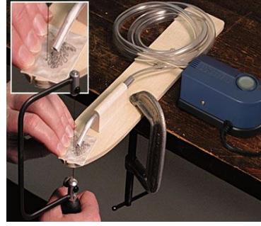
Resim 2.10: Şablonun tezgâha bağlanması ve kesimi
