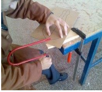
Resim 2.10: Şablonun tezgâha bağlanması ve kesimi
