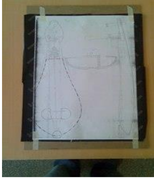
Resim 2.6: Plan resmin karbon kâğıdıyla şablon malzemeye aktarılması
