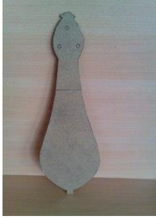
Resim 2.8: Testere ile Mdf'den çıkarılmış şablon
