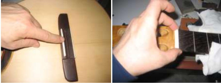
Resim 2.13: Üst eşik ve alt eşiğin yerine montesinin yapılması
