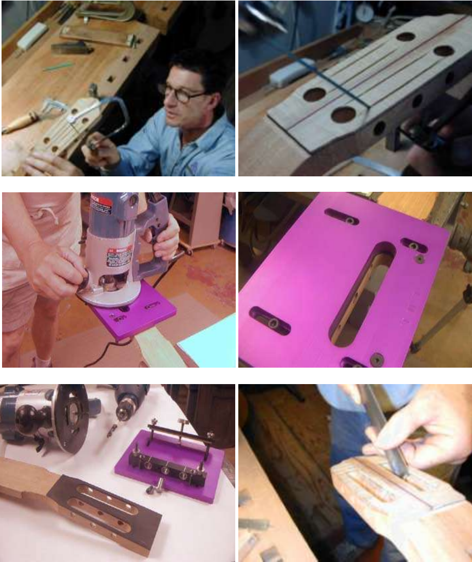
Resim1.9: Burguluk formunun frezeyle veya törpüyle boşaltılması
