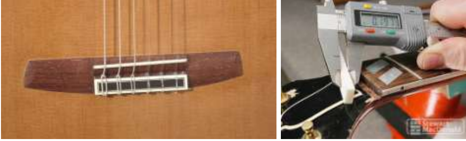
Resim 2.9: Köprünün yerine montesinin yapılması
