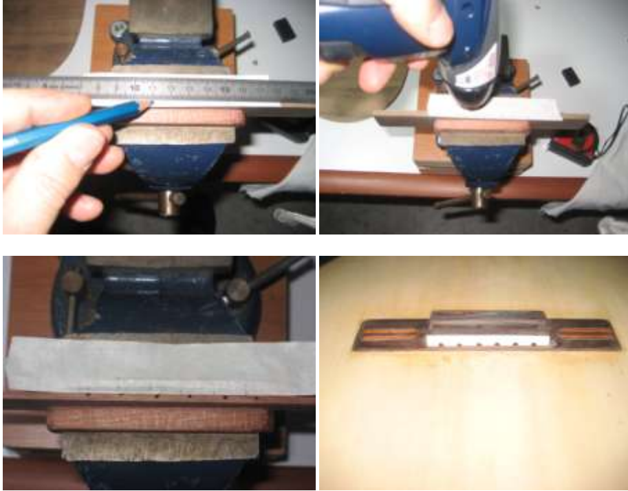
Resim 2.6: Köprüye tel deliklerinin açılması
