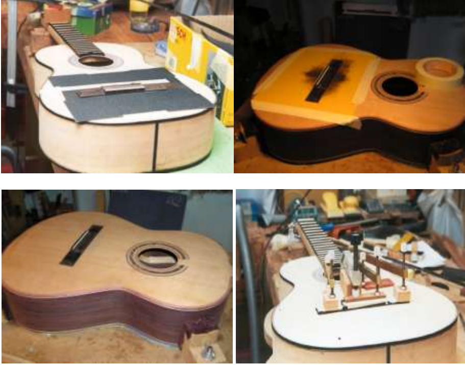
Resim 2.8: Köprünün yerine montesinin yapılması
