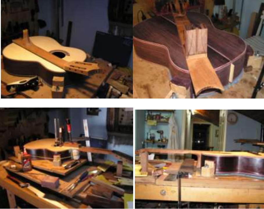
Resim1.12: Sapın ses kutusuna montajı
