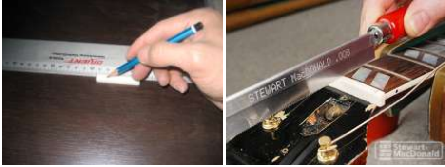
Resim 2.12: Üst eşiğe tel kamalarının açılması
