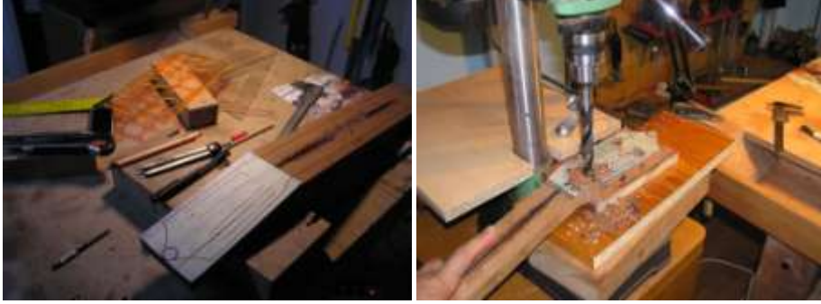
Resim1.8: Burguluk formunun çıkarılması
