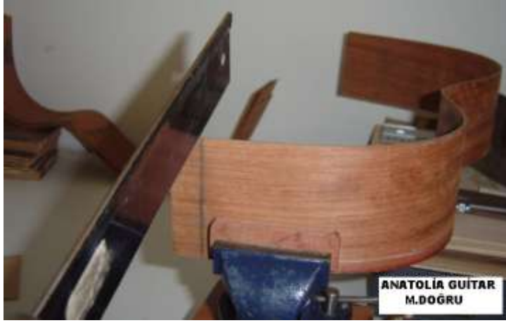
Resim 2.11: İki yanlığın arkasının ahşabın altına yerleştirilmesi
