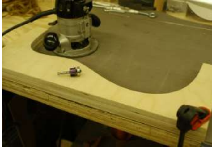
Resim1.6: Kalıbın tesviye edilmesi
