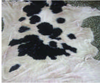
Resim 1.4. : Tüylü derinin kireç ve zırnık kireçliğinden sonraki durumu
