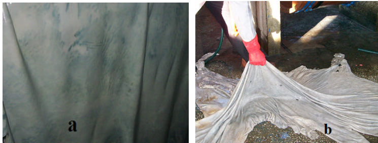
Resim 2.7: a) Tolanın kireç gidermede fiziksel olarak ara kontrolünün yapılması, b) Kireç giderme işlemi yapılmış deri düzgün ve yumuşak sırcalı olur.
