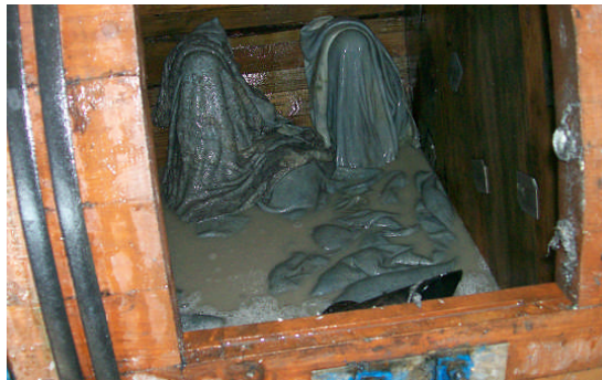
Resim 2.8: Kireç giderme esnasında derilerin dolap içerisindeki görünümü
