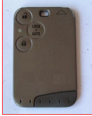
Resim 1.2: Kartlı sistem uzaktan kumandalı kapı kilidi
