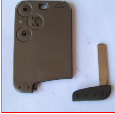
Resim 1.2: Kartlı sistem uzaktan kumandalı kapı kilidi
