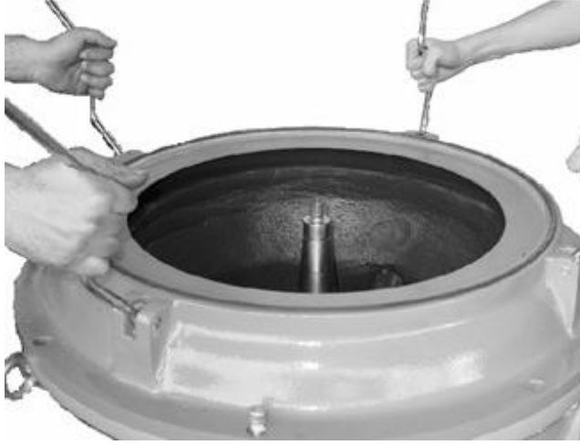
Resim 2.45 : Seperator gövdesinin sökülmesi
