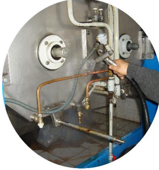
Resim 2.15 : Malaksörün yan tarafının tazyikli sıcak su ile yıkanması
