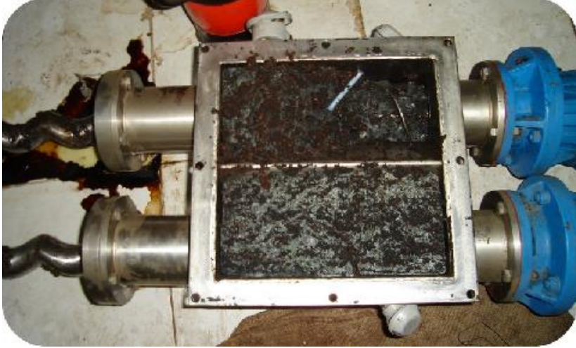
Resim 2.19 : Hamur pompası haznesinde bekleyen hamurun katılması
