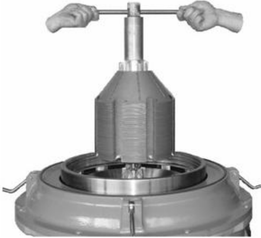
Resim 2.37: Konik çanakların sökülmesi
