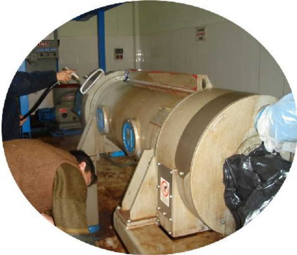
Resim 2.21 : Dekantörün dıřının tazyikli sıcak su ile yıkanması
