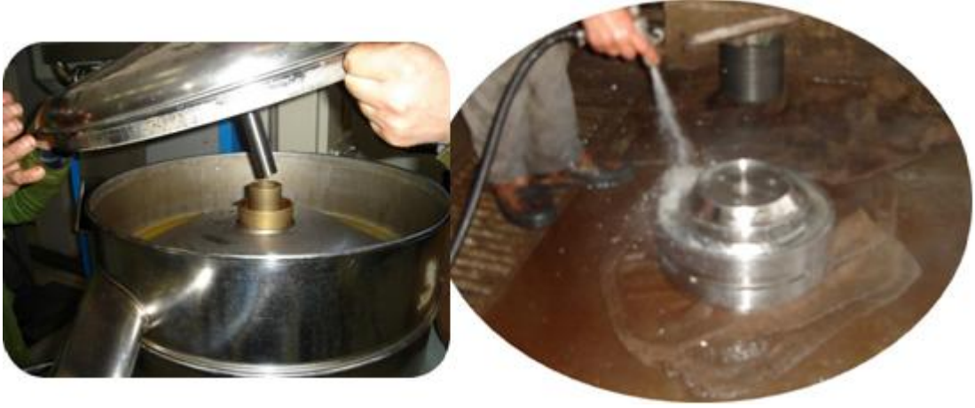
Resim 2.30 : Üst çanak gurubunun sökülmesi Resim 2.31 : Tamburunun sıcak su ile yıkanması
