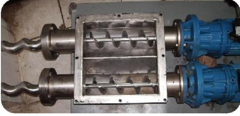
Resim 2.18 : Hamur pompası haznesinde temizlenmesi
