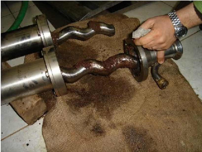
Resim 2.20 : Hamur pompasının bakımının yapılması
