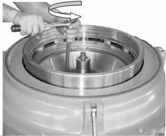
Resim 2.42 : Tambur civatasının sökülmesi
