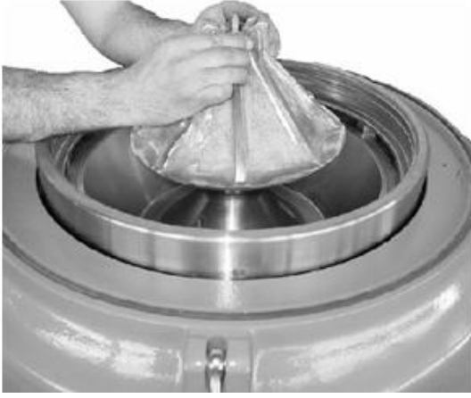
Resim 2.39 : Konik çanakların sökülmesi
