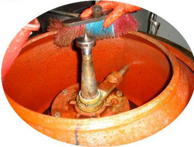
Resim 2.49: Seperatörün içinin fırça ile temizlenmesi
