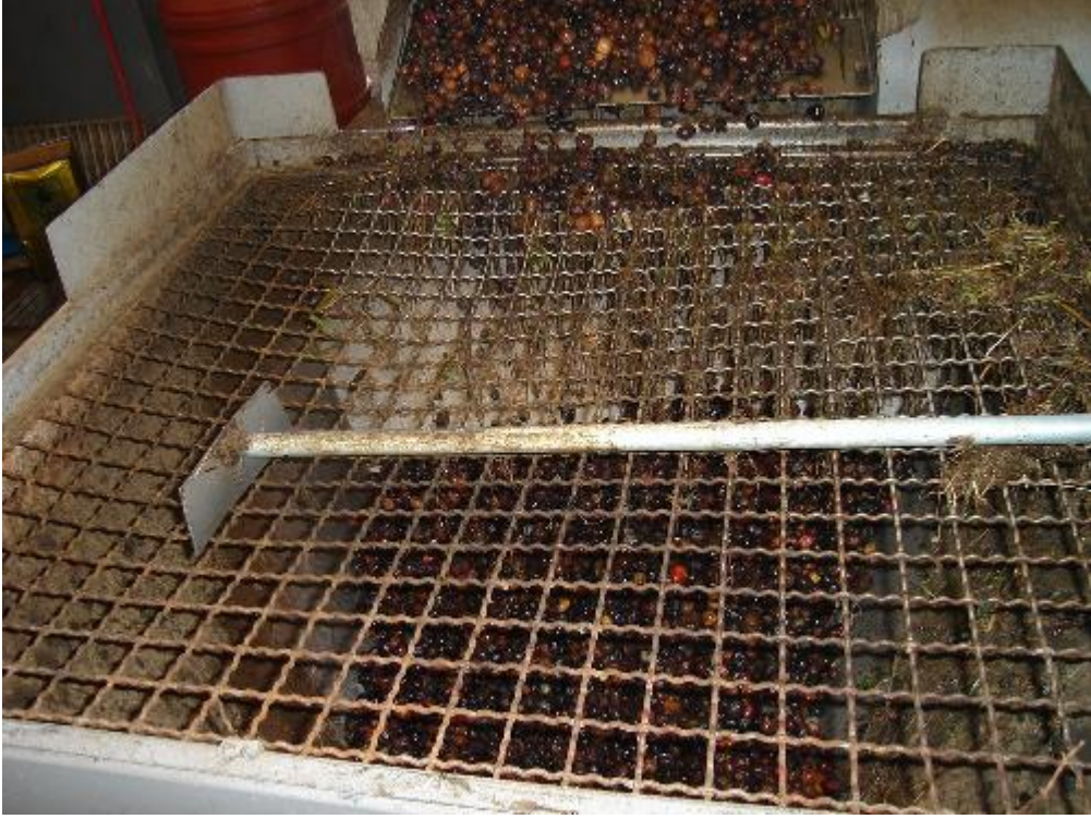
Resim 2.1 : Bunkerin üzerinde biriken yaprakların temizlenmesi
