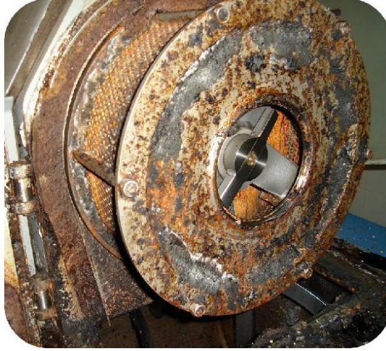
Resim 2.10 : Üzeri zeytin hamuru ile sıvanmış kırıcı gurubu
