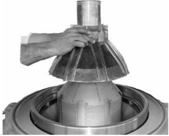
Resim 2.36 : Üst fener şapkasının sökülmesi
