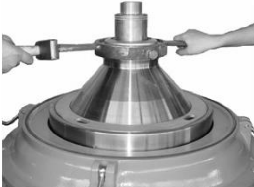
Resim 2.33 : Diyafram somunun sökülmesi
