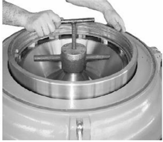
Resim 2.40 : Pistonun çekirme ile sökülmesi
