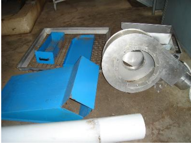
Resim 2.5 : Yaprak ayırma fanının temizlik ve bakımının yapılması
