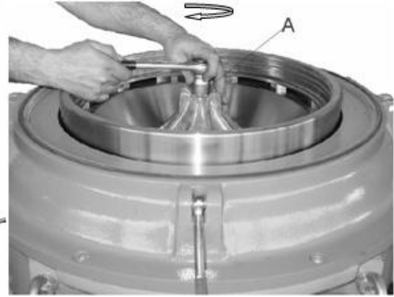
Resim 2.38 : Fener alt ahtapot somunun sökülmesi
