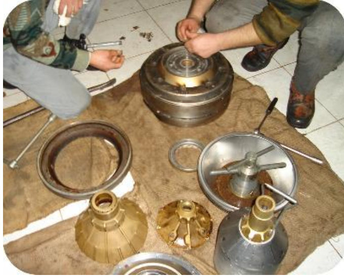
Resim 2.48 : Tamburun ters çevrilerek parçalarına ayrılması
