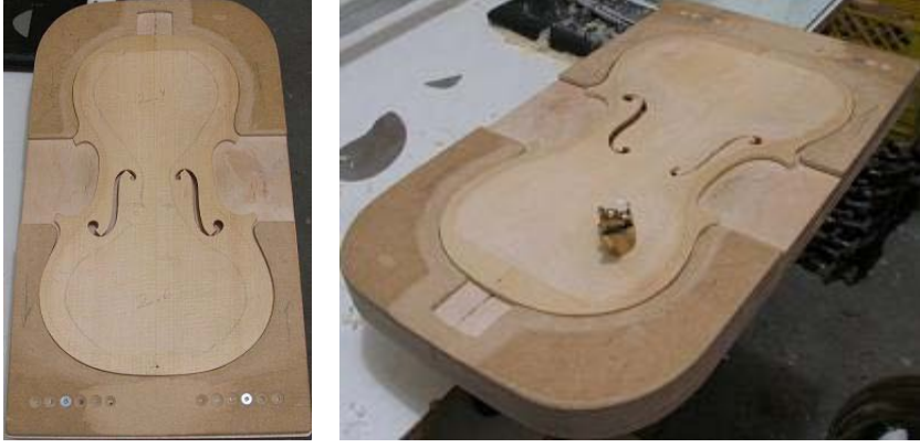
Resim 1.4: Ses tablosunun iç bombesinin hassas düzeltilmesi
