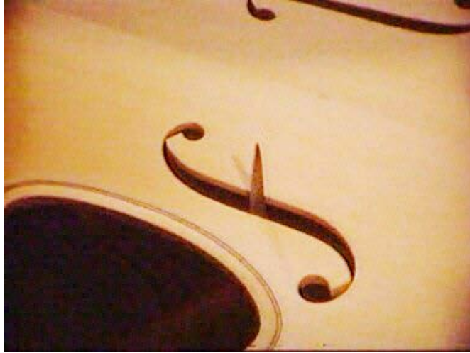
Resim 1.3: F deliklerinin düzeltilmesi
