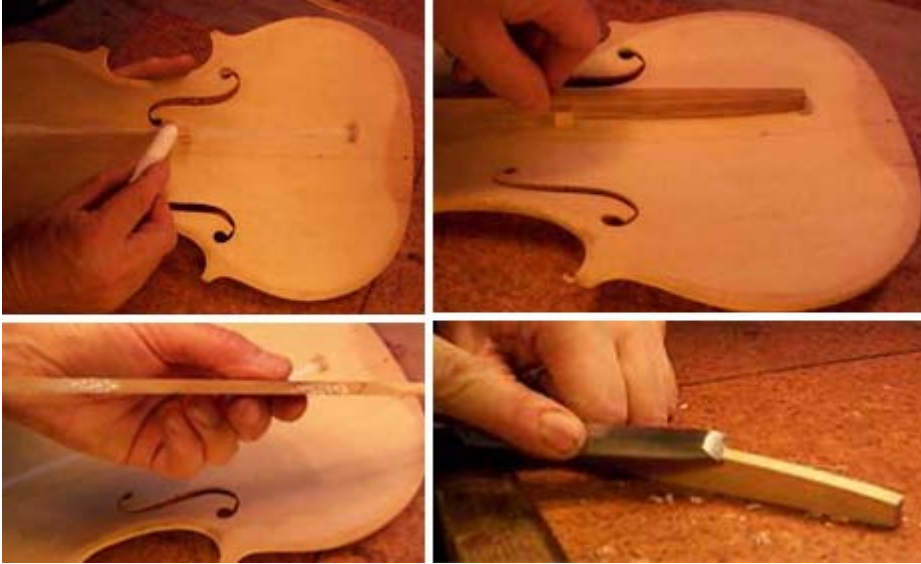
Resim 1.4: Bas ıtasının alıřtırılması
