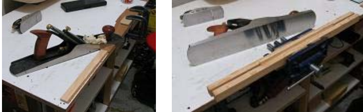
Resim 1.3: Bas çıtasının kalınlığının ayarlanması
