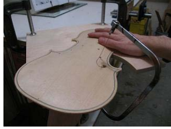
Resim 1.2: F deliklerinin kesilmesi
