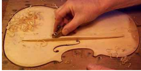
Resim 1.5: Bas çitasının şekillendirilmesi
