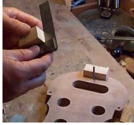
Resim 2.2: Blokların gönye ile kontrolü
