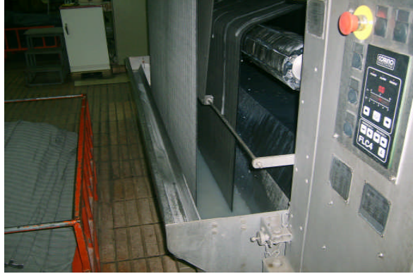
Resim 2.3: Kumaşın apre işlemi için fularda girişi
