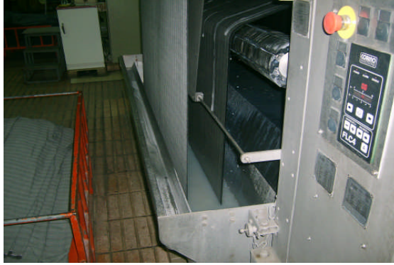
Resim 1.3: Kumaşın apre işlemi için fularda girişi
