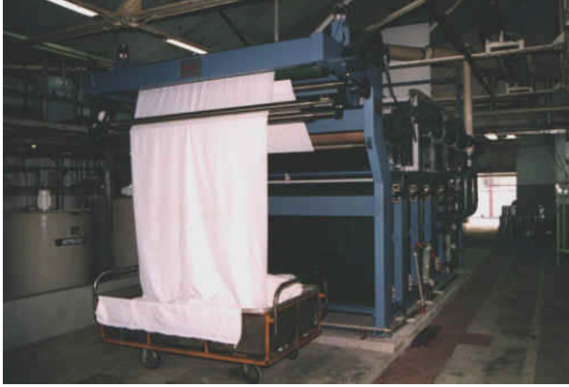
Resim 1.1: Kumaşın apre işlemi için Kroy Deepim makinesine girişi
