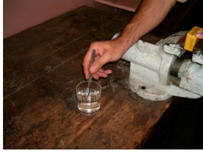
Resim 5.4: Kesim işleminde suyun kullanılması
