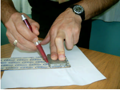
Resim 2.1: Flaş yardımı ile kauçuğun çizilmesi
