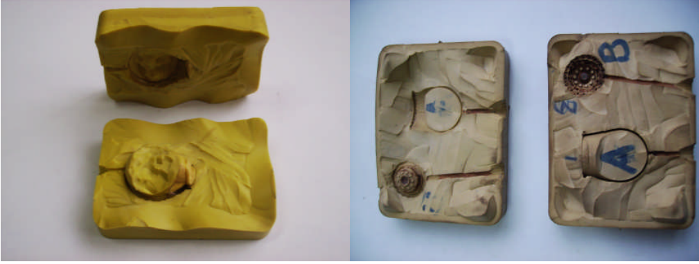
Resim 2.7: Kesim işleminin köşelerden derin zikzaklar oluşturacak şekilde başlaması
