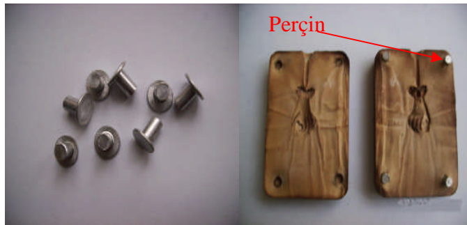
Resim 1.5:Merkezlemede kullanılan perçin ve kalıplanmış hali
