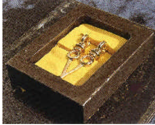
Resim 4.1: Modelin kalıba yerleştirilmesi
