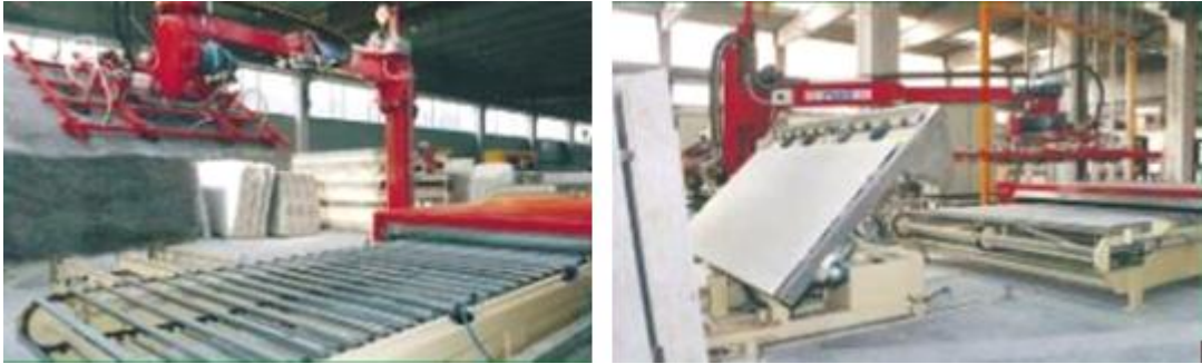
Resim 2.9: Robot kol tarafından yapılan plaka istiflemesi
