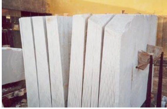
Resim 2.6: Blokun kesiminin tamamlanması ve vagonun katraktan çıkartılması
