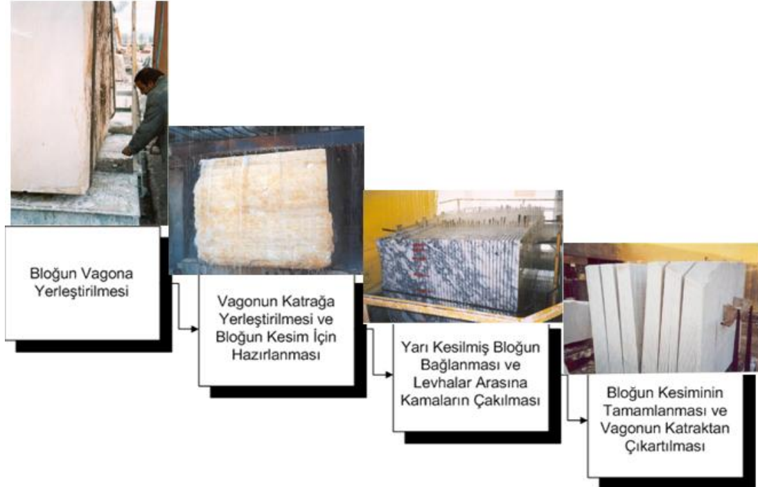
Resim 2.1: Katrakta plaka kesim aşamaları
