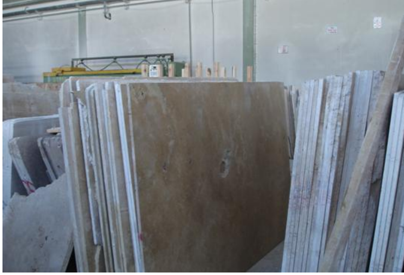
Resim 2.8: Katrakta kesilmiş plakaların istiflenmiş hâli
