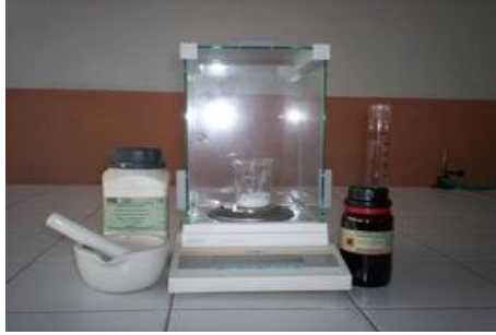
Resim 3.1: Erio chrome black T indikatörünün tartımı
