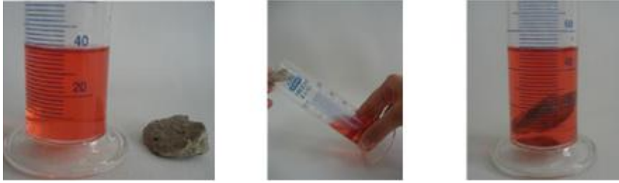
Resim 2.4: Boyutları ölçülemeyen katı maddelerde hacim ölçümü
