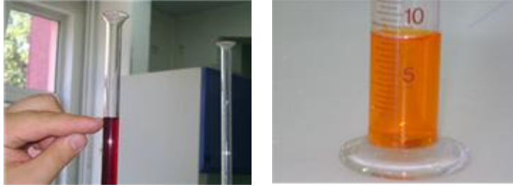
Resim 2.5: Renkli sıvılarda menisküs ve hacim okuma
