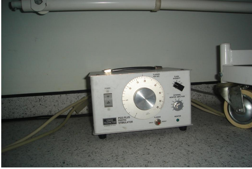
Resim 3.3: EMG-ENG cihazı photik stimülatörü
