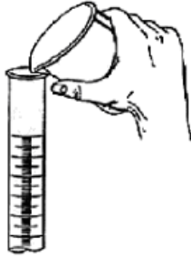
3- Buret kullanılacak titrant ile sıfır çizgisine kadar doldurulur.
