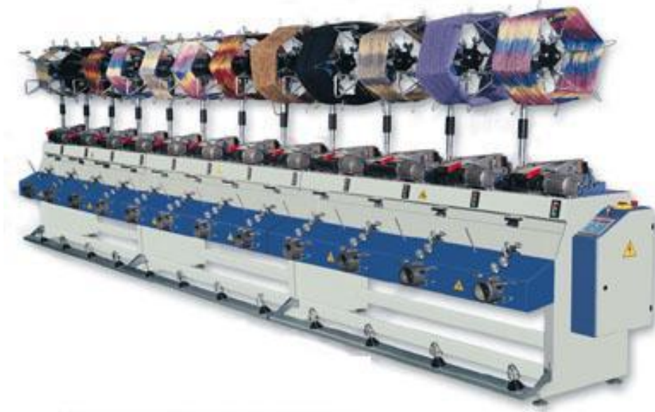
Resim 2.2: Bobin boyama için çile hâlindeki ipliğin bobinlenmesi
