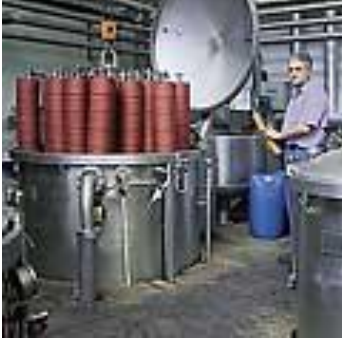
Resim 2.6: HT bobin boyama makinesinde boyanmış iplikler
