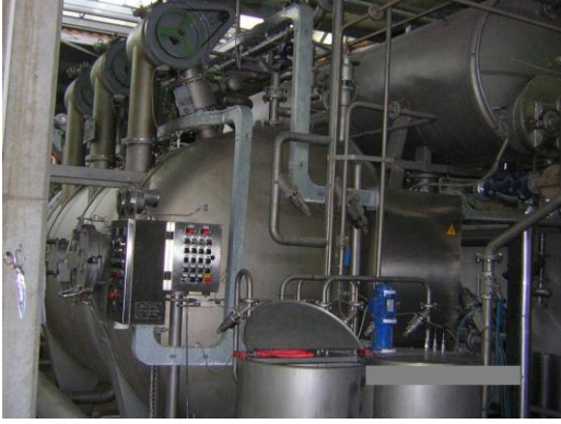
Resim 2.9: Pamuk/viskon karışımı kumaşın çektirme yöntemi ile boyanması
