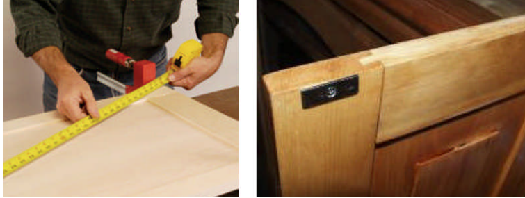
Resim 1.11: Hampaylı ve zıvanalı çerçeve köşe birleştirmeli yapılmış kapak
