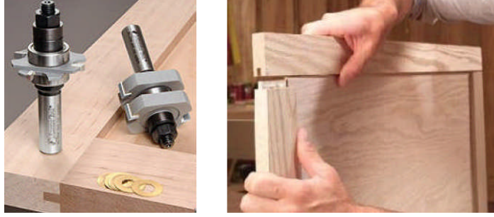
Resim 1.10: Hampaylı ve zıvanalı çerçeve köşe birleştirmeli kapak yapımı
