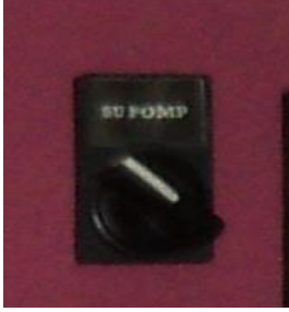
Resim 2.3: Su pompası açma düğmesi
