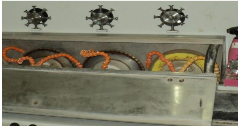
Resim 1.10: Makine üzerinde sırasıyla çizici taş ve kaba kanal taşı, ince kanal taşı
