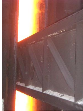
Resim 1.3 :Kömürün fırından itilmesi
