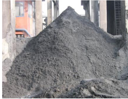
Resim 2.9: Havuzdan çıkan kok tozu hemen havuzun yanına yığılır.
