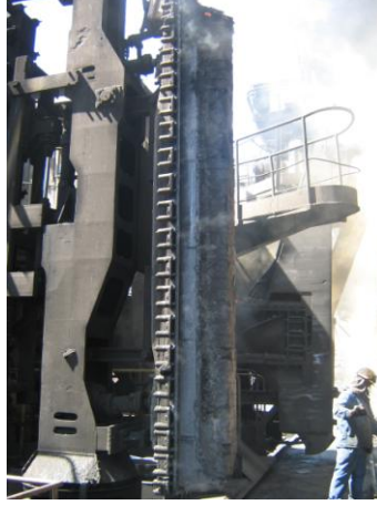
Resim 1.7: Fırın kapısının alınışı
