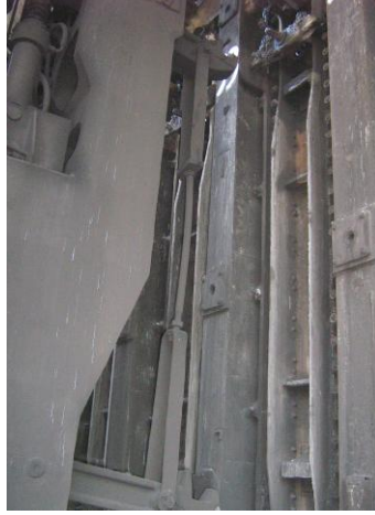
Resim 1.4: Açılmaya hazır kok fırın kapısı
