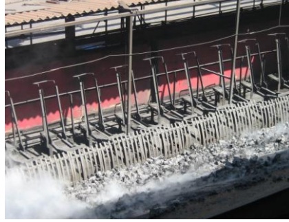
Resim 2.12: Kömürler rampalara yayılarak boşaltılır.
