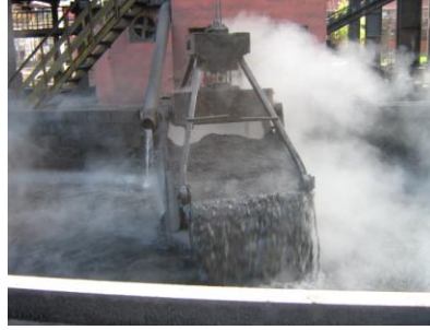
Resim 2.8: Havuzun dibindeki kok tozunun temizlenmesi
