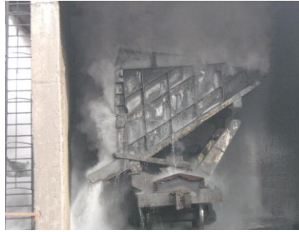
Resim 2.10: Sulu söndürme istasyonunda söndürülmekte olan kömür
