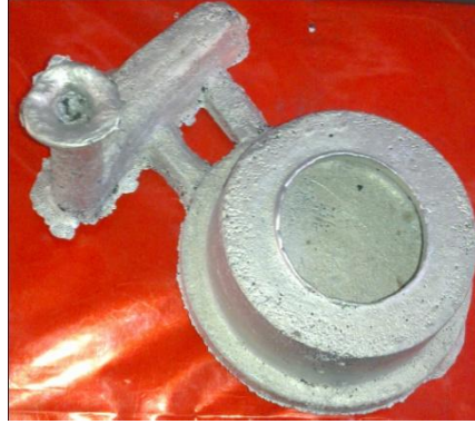
Resim 2.3: Vagonet tekeri döküm çıkmış hâli
