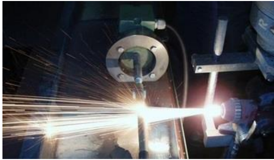
Resim 3.26: Çelik şaft üzerine molibden kaplanma yapılırken
