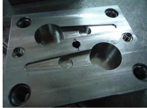
Resim 2.34. Dişi plaka üretimden sonra
