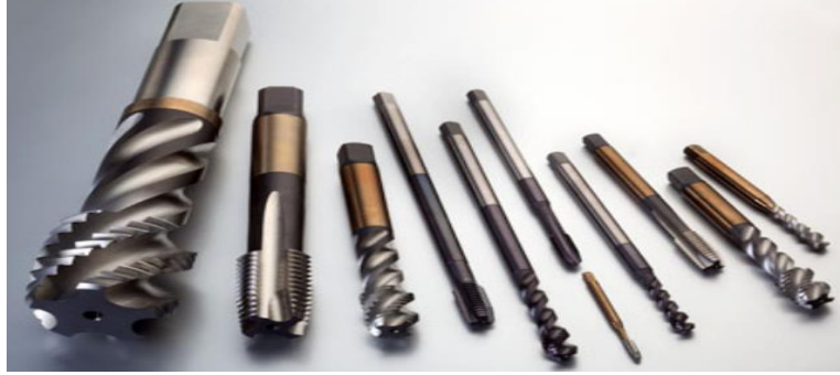
Resim 1.11. Alařımlı elikten yapılmıř kesiciler
