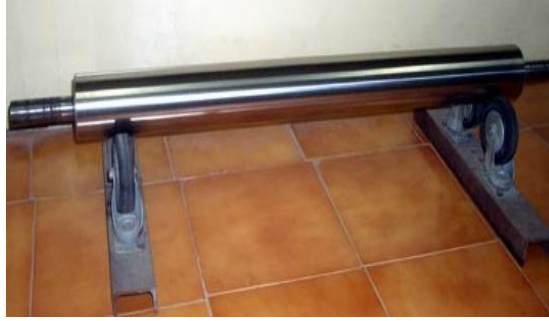
Resim 3.23: Ark sprey yöntemi ile özel alaşımli paslanmaz çelikle kaplanmış matbaa makinesi su püskürtme merdanesi
