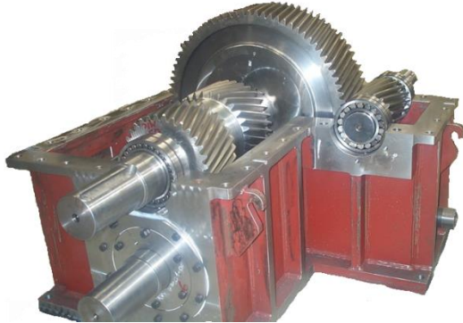
Resim 1.4.İnce taneli imalat çeliğinden yapılmış kaynaklı redüktör gövdesi ve sementasyon çeliğinden yapılmış dişliler ve kaplin parçaları
