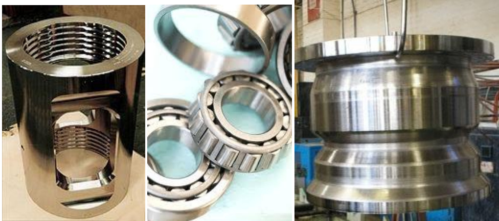
Şekil 3.27: Akımsız nikel kaplama yapılmış parçalar
