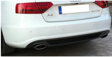
Resim 2.21: UP'nin tipik kullanılışı (taşıt tamponları, su tankları )
