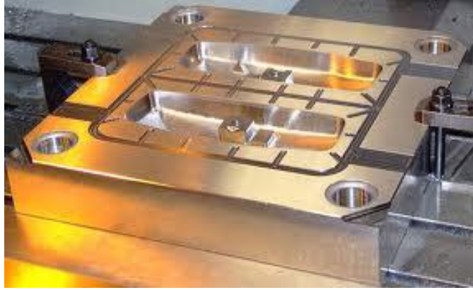
Resim 1.9. Sıcak iş çeliğinden yapılmış kalıp
