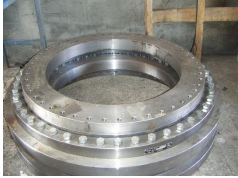
Resim 1.3.İnce taneli imalat çeliğinden yapılmış iş parçası
