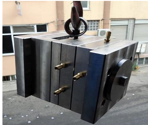
Resim 2.39. Kalıpta mapa kullanılması
