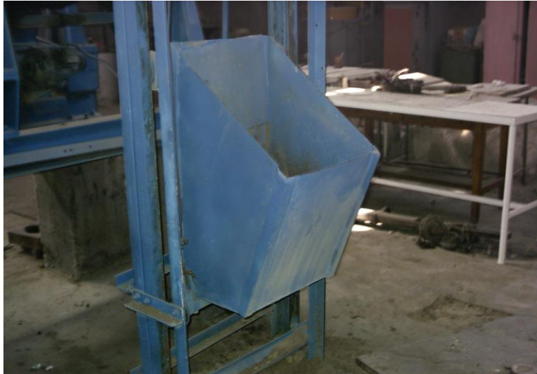
Resim 2.3: Koller kovası Özel tartı kabı ile yükleme
