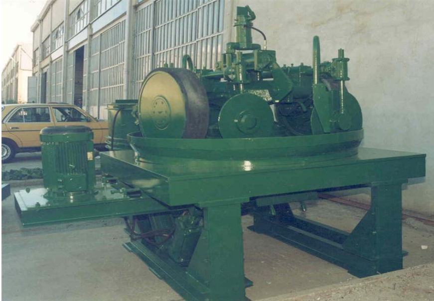
Resim 2.2: Silindirli kum hazırlama makinesi
