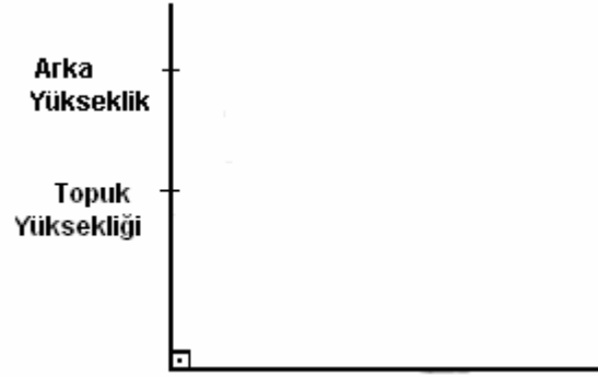
Şekil 1.20: Açı kolu üzerinde arka yükseklikleri işaretleme
