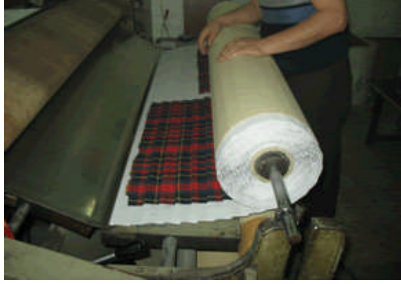
Resim 1.3: Plise makinesinin çıkış kısmında kumaşın plise kâğıdına sarılarak alınması
