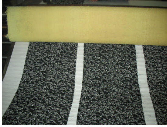
Resim 1.10: Plise tekniği ile krinkıl yapma
