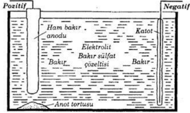
Resim 2.2: Elektrolitik bakır arıtımı
