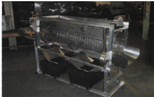
Resim 2.16: İstiridye temizleme ve yıkama makinesi
