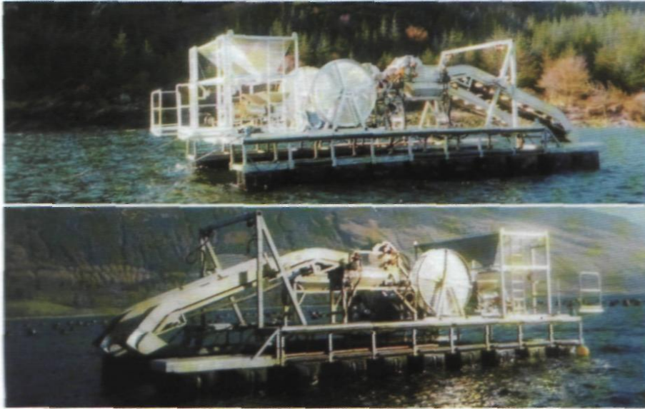
Resim 1.9: Denize şamandıralar üzerinden halat bırakan ve toplayan makineler
