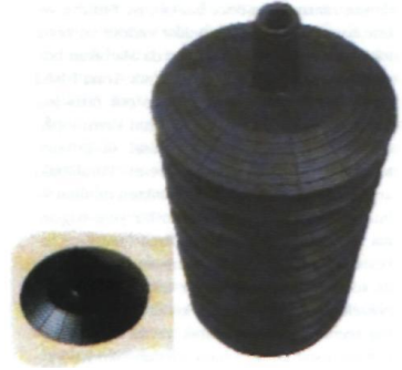
Resim 2.3: Yavru toplama işlemlerinde kullanılan tabla
