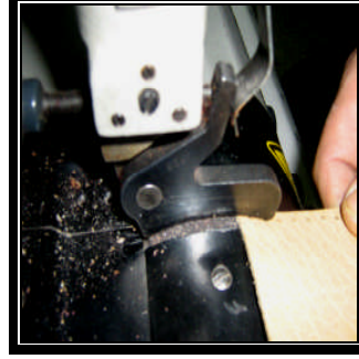
Resim 2.6: Makinede köseleyi tıraşlama ( Geniş yüzeylerde )
