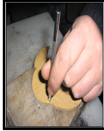
Resim 5.20: Çelik çubuklar ile motif oluşturma
