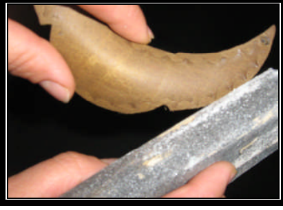
Resim 4.3: Kesilen köselenin zımparalanması
