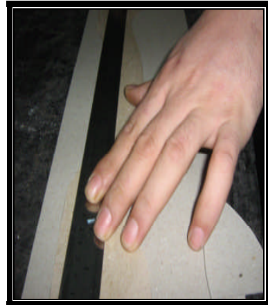
Resim 3.4: Köseleye cetvel ile kalıp çizme
