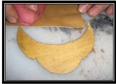
Resim 4.2: Çizilen kalıbın kesilmesi
