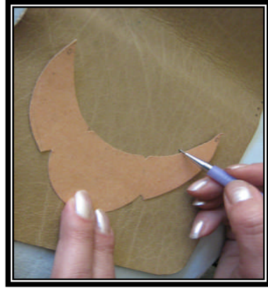
Resim 3.2: Köseleye kalıp çizme
