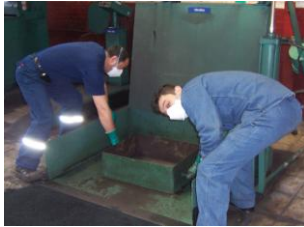
Resim 1.14: Ölçme kutusunun platforma yerleştirilmesi
