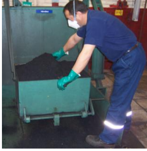
Resim 1.11: Bunkerin yüzeyinin düzeltilmesi
