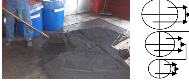
Resim 1.7:Dörtleme metodunun yapılış şematik resmi
