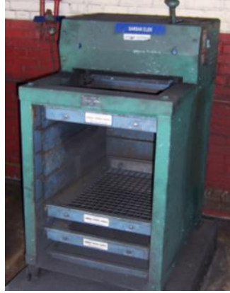
Resim 2.3: Kok kömürü elemede kullanılan sarsak elek
