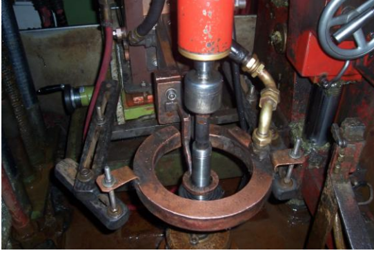
Resim 2.2: Isıyı yüzeye uygulama prensibi
