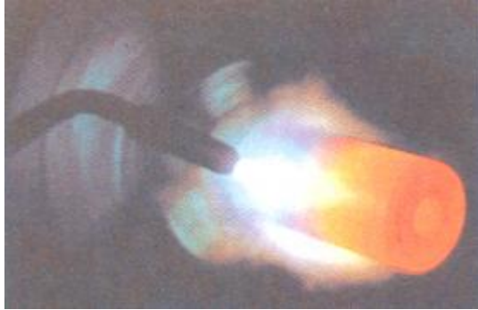
Resim 1.3: Alevi yüzeye uygulama mesafesi ayarlanarak yapılan ısıtma işlemi
