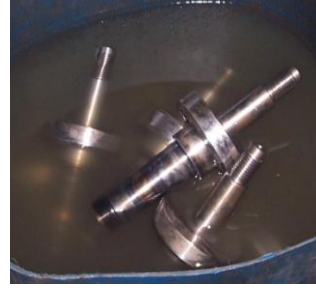
Resim 2.8: Isıtılan yüzeye soğutma sıvısı uygulama
