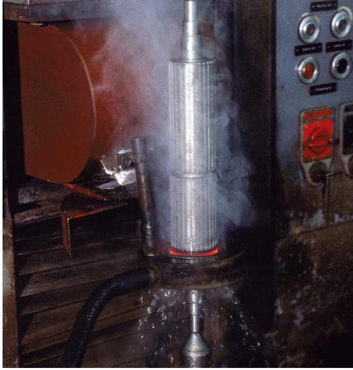
Resim 2.5: Endüksiyon akımı ile yüzey sertleştirme işlemi
