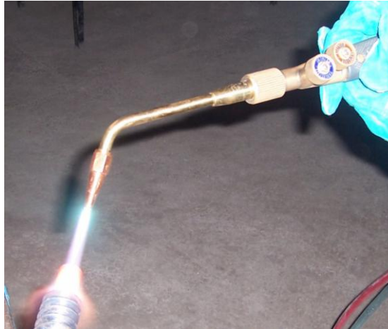
Resim 1.2: Parçaya göre alevin ayarlanarak ısıtılması
