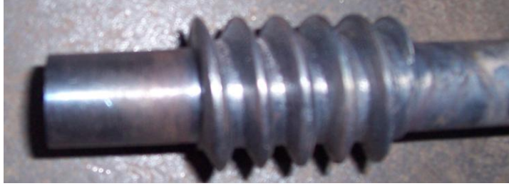
Resim 1.11: Alevle yüzey sertleştirme işlemi görmüş parça
