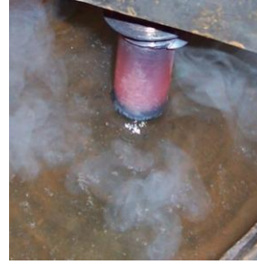
Resim 1.9: Isıtılan yüzeye su uygulanarak sertleştirme işleminin gerçekleştirilmesi
