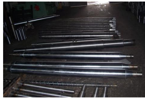
Resim 2.4: Endüksiyon akımı ile yüzeyi sertleştirme işlemi görmüş çelikler
