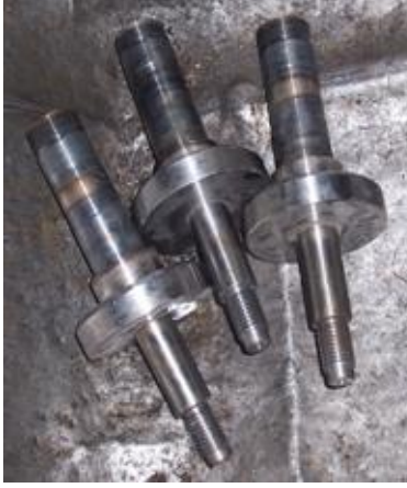
Resim 2.10: Endüksiyon akımı ile yüzeyi sertleştirilmiş çelik
