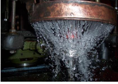
Resim 2.8: Isıtılan yüzeye soğutma sıvısı uygulama
