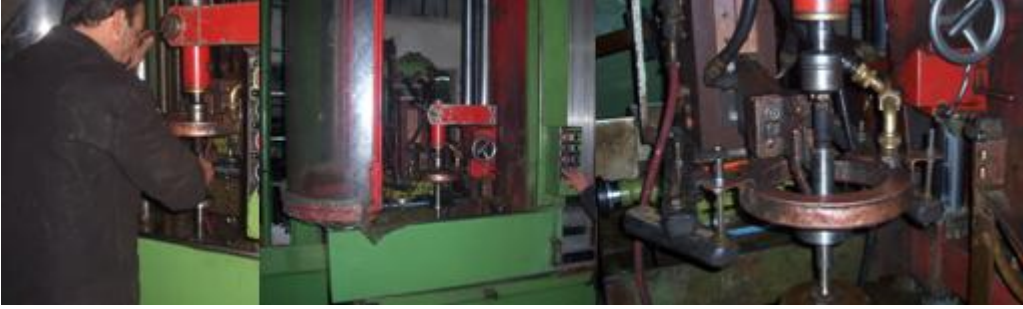
Resim 2.6: Isıtılacak malzemenin makineye yerleştirilmesi
