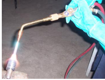
Resim 1.6: Parça kalınlığına uygun alevi malzeme yüzeyine doğru bir şekilde uygulama
