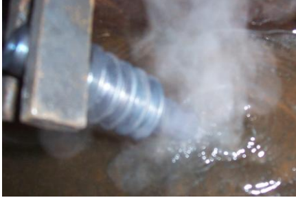
Resim 1.9: Isıtılan yüzeye su uygulanarak sertleştirme işleminin gerçekleştirilmesi
