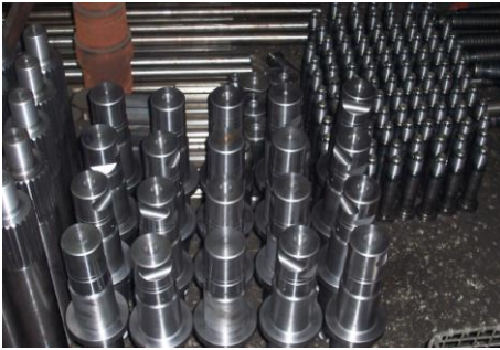
Resim 2.4: Endüksiyon akımı ile yüzeyi sertleştirme işlemi görmüş çelikler
