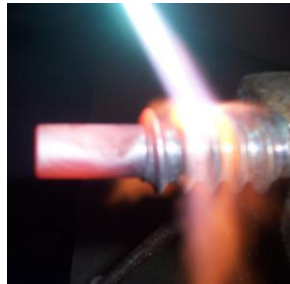
Resim 1.8: Malzeme yüzeyini tavlama
