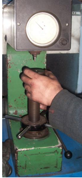
Resim 1.10: Yüzeyi sertleştirilmiş malzemenin sertliğinin kontrol edilmesi
