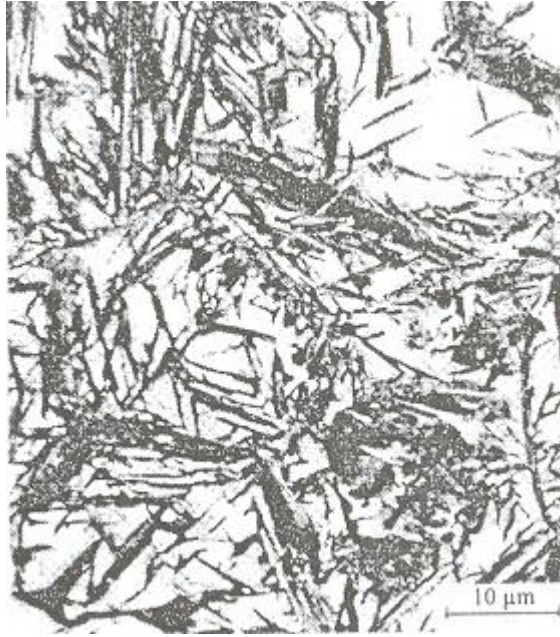
Şekil 1.8: Çeliklerde su verme sonucunda oluşan martenzitik yapı
