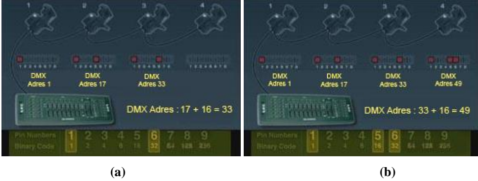
Resim 1.19: DMX uyumlu cihazların DMX adres pinlerinin ayarlanması
