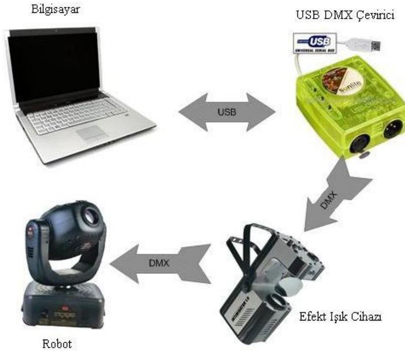
Resim 1.4: Işıklandırma sisteminde kullanılan cihazların bilgisayar bağlantısı
