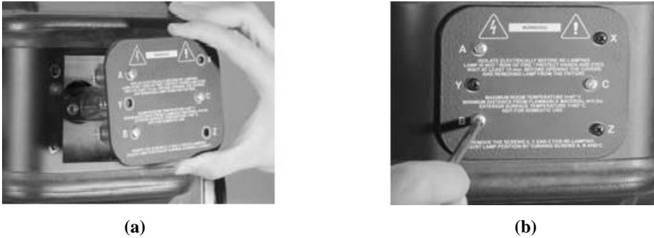
Resim 4.9: Cihazda lamba değişiminin tamamlanması
