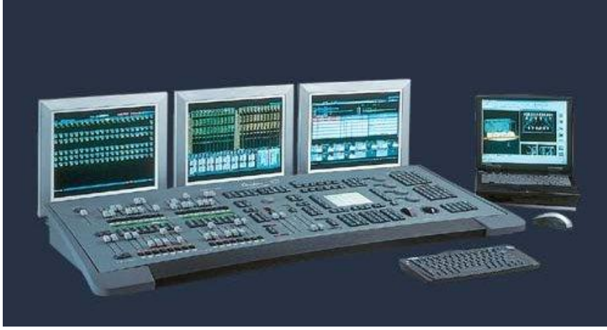
Resim 3.11: Tüm sistemin kontrolünü sağlayan DMX paneli
