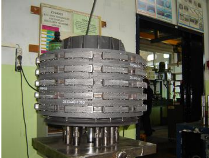
Resim 4.1: Fren statorundaki karbon diskler
