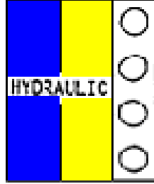
Şekil 1.8: Boru Üzerindeki Hidrolik Renk Kodu
