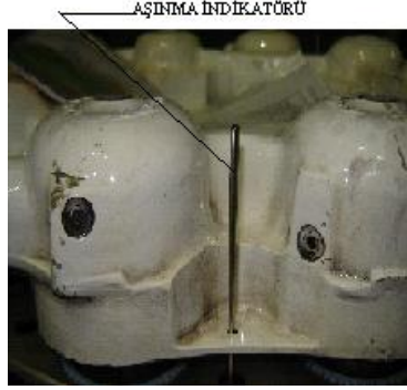
Resim 4.2: Fren diski aşınma indikatörü
