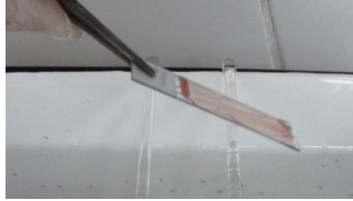
Resim 2.43: Yayma preparat üzerindeki alkolü dökme
