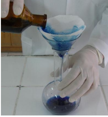
Resim 2.28: Bekletilen boyanın süzülmesi
