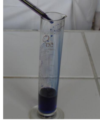
Resim 2.21: Tampon çözeltiye stok giemsa boyasının eklenmesi
