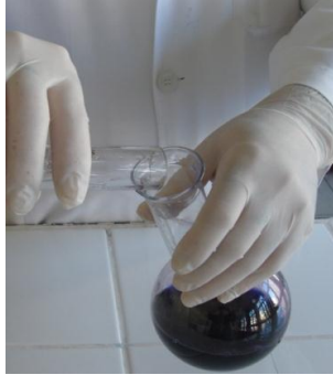
Resim 2.16: Boyaya metil alkol eklenmesi
