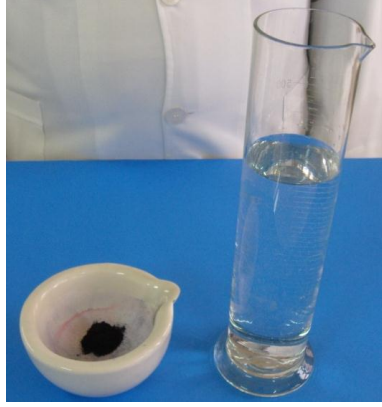
Resim 2.2: Tartılan boyayı havana koyma ve metil alkolü ölçme
