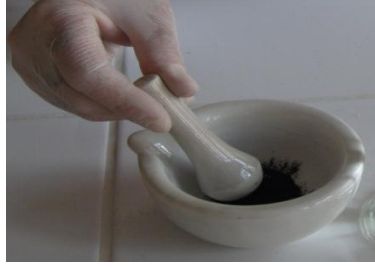
Resim 2.24: Boyanın havanda ezilmesi
