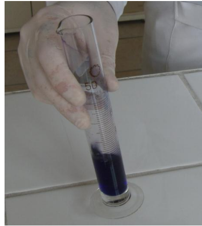
Resim 2.31: Boya ile distile suyu karıştırma
