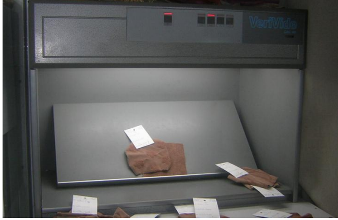
Resim 1.3: Işıklı kabinde numune kontrolü
