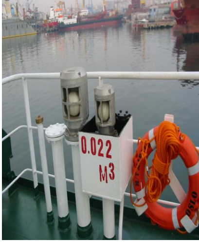
Resim 2.3: Güvertedeki hava firar boru bağlantıları
