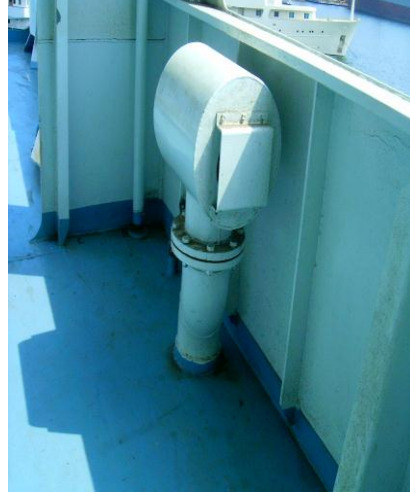
Resim 2.3: Güvertedeki hava firar boru bağlantıları
